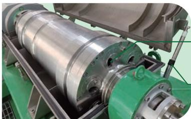
Водосливная перегородка с регулировкой глубины, удобная и гибкая, можно удовлетворить различные условия обработки сухой влажности и осветления.
