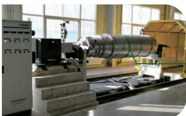
После того, как основные вращающиеся детали обработаны высокоточным оборудованием с ЧПУ. Центрифуга проходит три динамических процесса балансировки: В том числе основной вращающийся корпус 1800RPM средней скорости динамического баланса. Высокоскоростной динамический баланс фактических рабочих скорости и полный маневренный баланс. Убедитесь что центрифуга работает стабильно в условиях высокой скорости.
