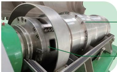
Материал вала и материал барабана торцевых крышки: Дуплексная нержавеющая сталь SUS2205 или SUS2304 Сделано центробежным литьем, характеристика лучше чем у сверстников SUS304 и SUS316: Основные детали изготавливаются методом центробежного литья и технологи ковки.
