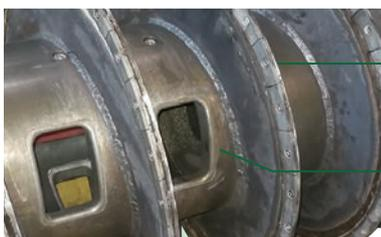
Толкатель защищен сменным износостойким листом из сплава, который длинен и прост в обслуживании.
