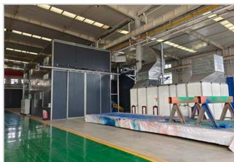
Включая пескоструйные и дробеметные установки, интегрированные помещения для распылительной сушки, сборочные линии для электростатического напыления порошка, системы контроля содержания летучих органических соединений, регулируемую запыленность и температуру в среде нанесения покрытий для обеспечения качества покрытия оборудования.
