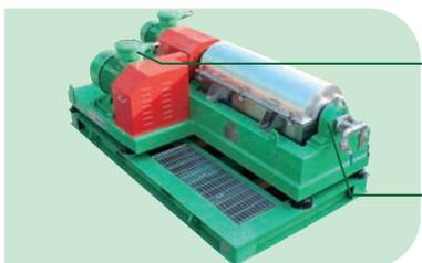
Два мотора расположены на одном конце центрифуги более компактная структура делает больше места для работы и обслуживания центрифуги, в то же время предотвращается повреждение двигателя из-за утечки материала со стороны подачи.
