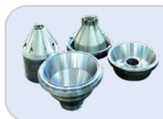
● Все ключевые детали барабана обрабатываются станками с ЧПУ, и после точной сборки каждой детали проводится проверка динамического баланса.. Барабан изготовлен из высокопрочного, коррозионно-стойкого материала из нержавеющей стали с помощью встроеннойковки под высоким давлением.
