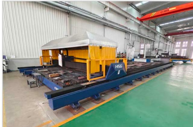
Большой станок для лазерной резки с ЧПУ
