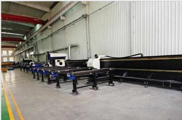
Большой станок для лазерной резки труб с ЧПУ
